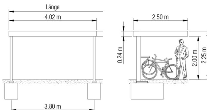
Der Universalunterstand HUEF zeichnet sich durch seine zeitlose Geradlinigkeit aus. Die stabilen Ausleger tragen das Dach ohne zusätzlich vorne liegende Stützen und ermöglichen somit optimale Begehbarkeit. Die in verschiedenen Farben erhältlichen Blendenbleche geben dem Unterstand das gewünschte Erscheinungsbild. Diverse Optionen wie bspw. Wände in verschiedenen Materialien ermöglichen eine individuelle Gestaltung und bieten zusätzlichen Schutz und Sicherheit.
