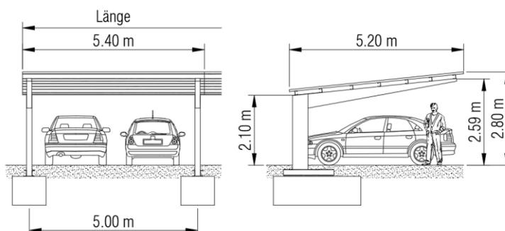
Der Autounterstand GEB zeichnet sich durch sein offenes Erscheinungsbild aus. Die stabilen Ausleger, welche mit massiven Fundamenten verschraubt werden, tragen das Dach ohne zusätzlich vorne liegende Stützen und ermöglichen somit optimale Befahrbarkeit. Diverse Optionen wie bspw. Wände oder Bedachungen in verschiedenen Materialien ermöglichen eine individuelle Gestaltung und bieten zusätzlichen Schutz und Sicherheit.
